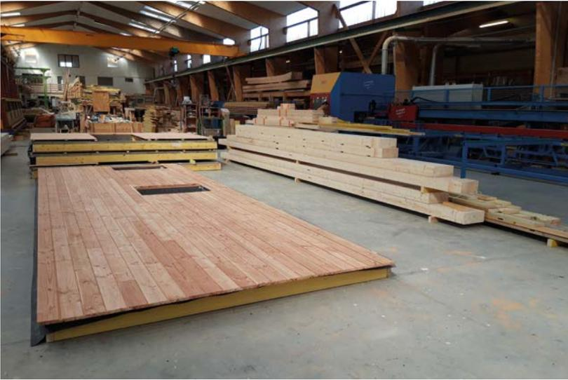
Assemblage de murs en ossature bois à l'atelier.
